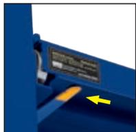
抽屉底部左右两侧，设有安全拉销，抽屉拉出或推入时，两侧拉销向外侧压，即可解开安全扣
